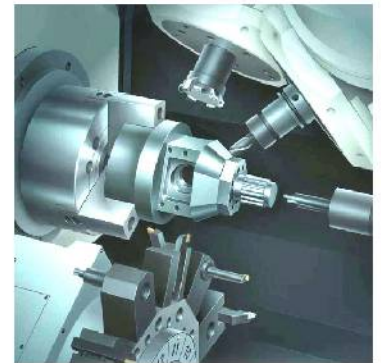
Tour à poupée fixe avec broche de reprise, tourelle et unité de fraisage 5 axes
